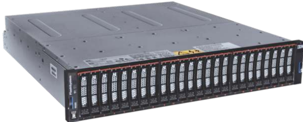
IBM Storage FlashSystem 5045 mit 24 2.5" SAS SSD Slots
