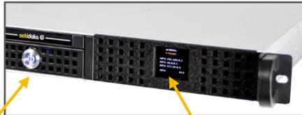
Ein-/Aus-Taster      Front-Panel IP, Temperatur, Luftfeuchte
